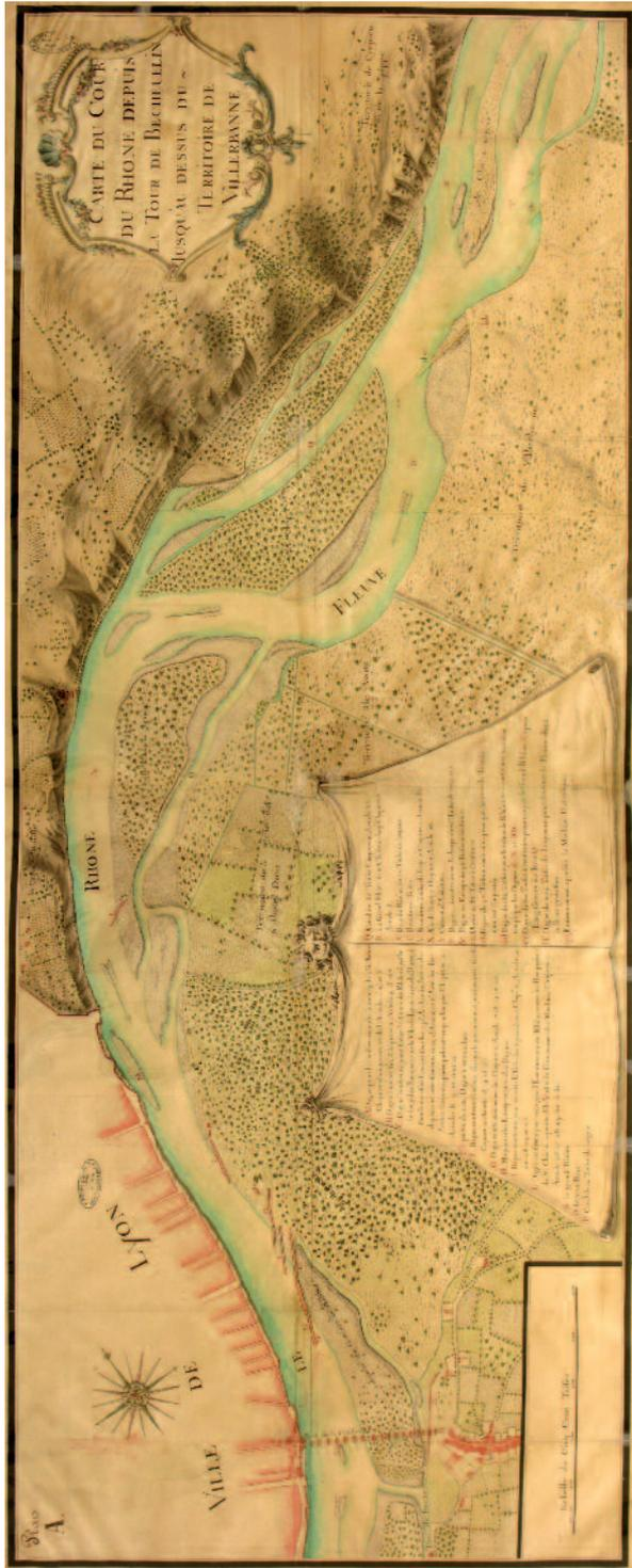
Fig. 8. Plan de Lallié, 1742, montrant la digue du XVII<sup>e</sup> siècle (ADR, 1 C 162). Reproduit avec l'autorisation des Archives départementales du Rhône. Ce plan est associé à un rapport sur les digues, publié par BURNOUF et al., *Le pont de la Guillotière*, p. 179-184. Il détaille l'état des digues et les nouveaux travaux à mener.
