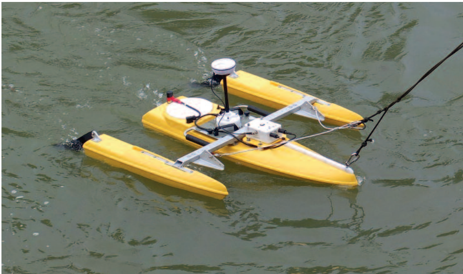
Fig. 7. ADCP SonTek monté sur flotteur.
