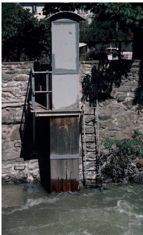
Fig. 3a. Limnigraphe avec flotteur sur la Saltine (Brigue). (Photo: Beat Sigrist).
