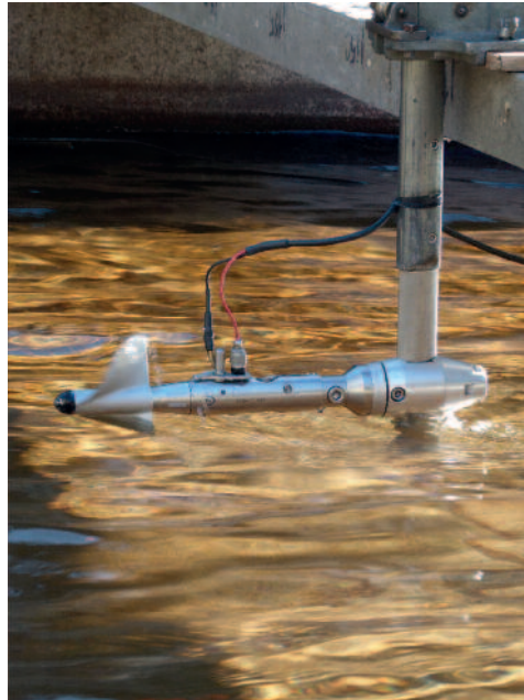
Fig. 4a. Moulinet hydrométrique fixé sur une perche.
