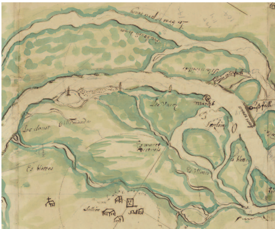
Fig. 9. Détail d'un plan du Rhône dressé en 1803. Les digues offensives, sur la rive droite du fleuve, sont bien visibles. Plan orienté vers le sud. (AEV, DTP, Plans, Rhône, 1).
